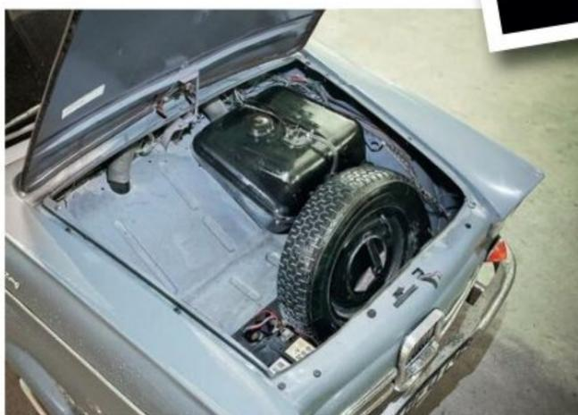
Réservoir d'essence, batterie et roue de secours, le compartiment avant est bien occupé !
